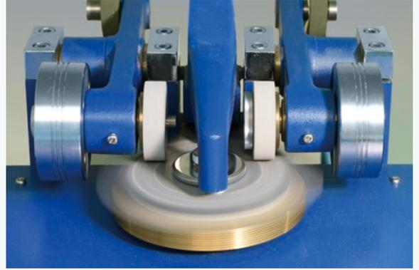
車両走行を想定し、防水層のすり減りを摩耗量で確認する試験。
