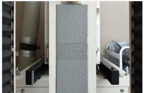
コンクリートに生じるひび割れを想定し、防水層の追従性を確認する試験。
