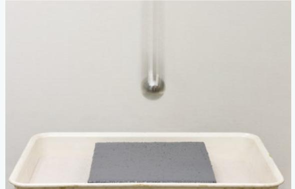
落下した荷物の衝撃を想定し、落球による防水層の浮き、ひび割れ、はがれの有無を確認する試験。
