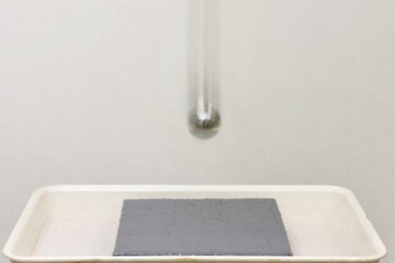
落下した荷物の衝撃を想定し、落球による防水層の浮き、ひび割れ、はがれの有無を確認する試験。
