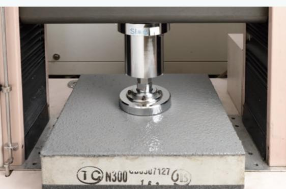
往来する大型貨物自動車などの荷重を想定し、繰り返し圧縮荷重を与えて防水層の破断や亀裂の有無を確認する試験。
