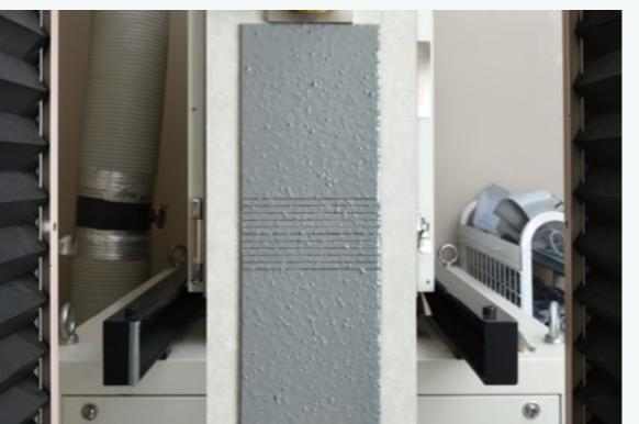
コンクリートに生じるひび割れを想定し、防水層の追従性を確認する試験。
